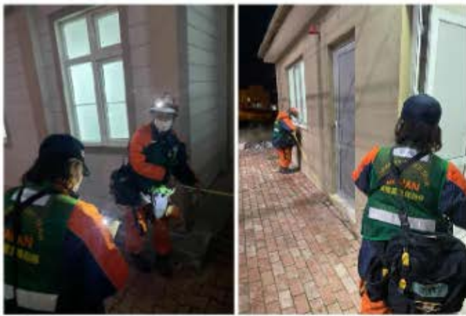
写真17・18 医療チーム拠点の応急危険度判定
